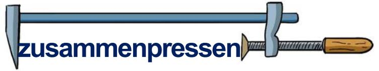
Mit der Schraubzwinge das Holz **zusammenpressen**.
